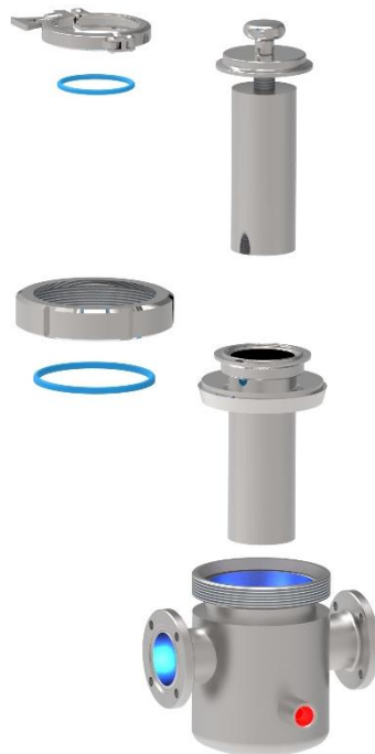
Inline-Filtergerät TR-1-60-100-50-HZ Abreinigungsvorgang
